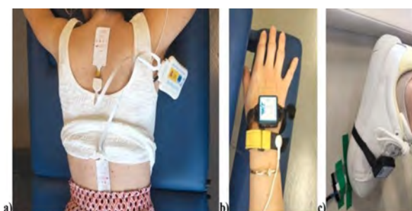
Figura 1. Posicionamiento del material empleado durante el registro del procedimiento experimental: a) 2 matrices de 32 electrodos para el registro de señales ESG a nivel braquial y lumbar, b) un electrodo de referencia y una IMU fijados en la mano derecha y c) una galga extensiométrica al alcance del pie y una IMU colocada sobre el antepié derecho con las que caracterizar el instante inicial durante la realización de movimientos.
