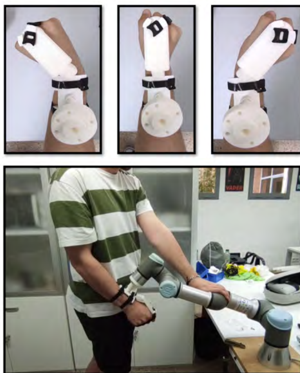
Figura 3. Ejemplo de agarre y manipulación del efector (arriba). Entorno real de experimentación (abajo).
