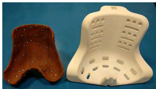
Figura 1. Lecho fabricado tradicionalmente frente a lecho fabricado por impresión 3D
