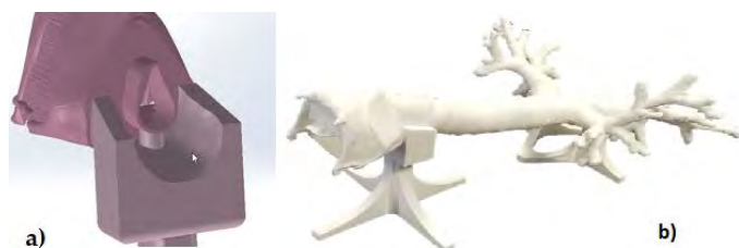
Figura 8. Glotis sujeta al soporte (a) y ensamblaje de todas las piezas que conforma el simulador completo final (b)
