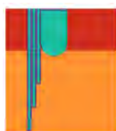
Figura 4. Modelo con sensores paralelos al catéter y sin separación.
