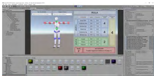
Figura 15. Integración de Mocap, sEMG y Sistema automático de evaluación ergonómica en Unity
