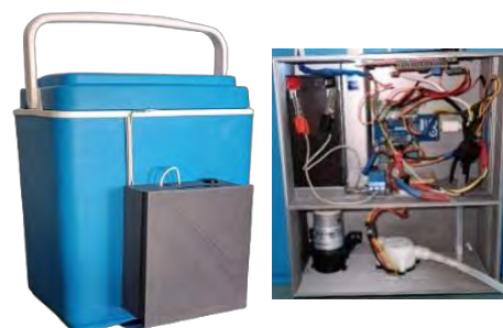
Figura 4. A la izquierda, la nevera con el circuito integrado en una caja de protección. A la derecha, la circuitería del sistema de monitorización y perfusión.
