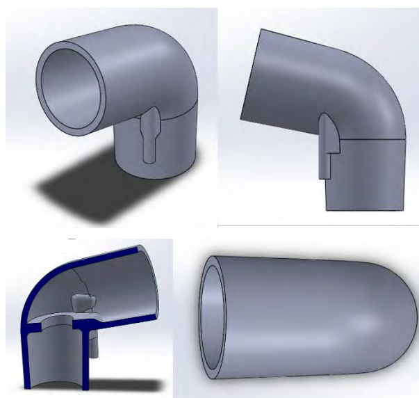
Figura 3. Modelado de codo. Pieza en “L”
