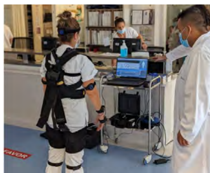
Figura 11. Mocap, sEMG y exoesqueleto durante el ensayo
