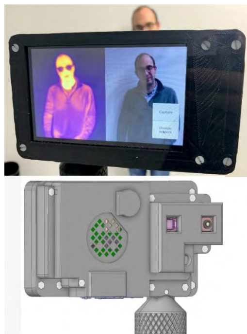
Figura 1. Sistema portátil utilizado. Implementación detallada del sistema. (a) Vista frontal. (b) Vista posterior. Tiene dos cámaras que funcionan simultáneamente. Uno opera en el espectro visible y la otra en la banda infrarroja.
