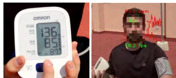
Figura 4. Comparación entre la salida del algoritmo Heartbeat en tiempo real con el dron estacionado (derecha, 59.5 LPM) frente a la salida del tensiómetro (izquierda, 87 LPM).
