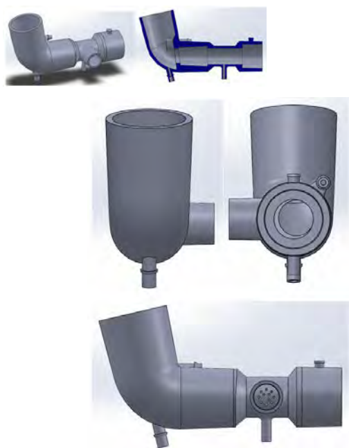
Figura 12. Modelo 3D del prototipo con toma inyectable externa
