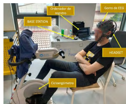
Figura 2. Montaje experimental. Se tapó la pantalla del cicloergómetro para evitar estímulos visuales externos en los usuarios.
