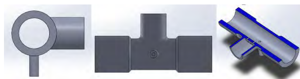
Figura 4. Modelado de conexión. Pieza en “T”
